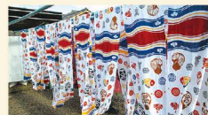
防染のりと余分な染料を水洗い後、乾燥。風合い、発色も良くなるため、必ず天日干し
